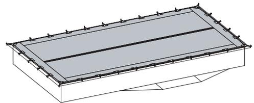
Fixer les Sandows sur les pitons comme décrit à l'étape 4, en commençant par le milieu des largeurs, et en s'assurant du bon centrage de la couverture.
