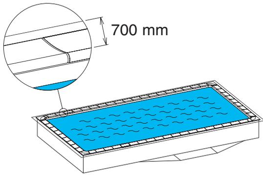
Tracer les axes de perçages des pitons à 700 mm du nez des margelles.
