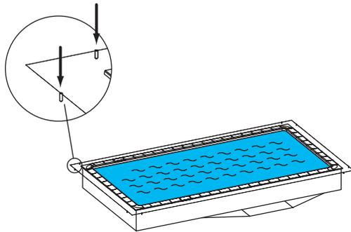
Percer dans les angles sur les axes de perçages tracés exactement en face des Fixkits sur une profondeur de 50 mm :
